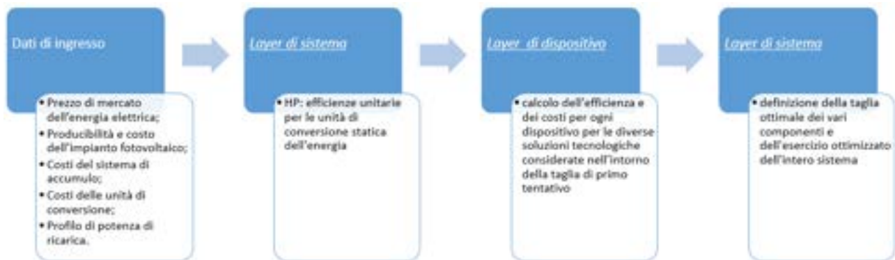
Figura 4 Flowchart del processo decisionale della piattaforma di progettazione
