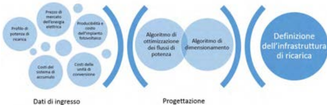
Figura 1 Schema di principio di funzionamento della piattaforma di progettazione dell'infrastruttura di ricarica
