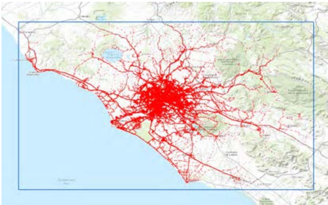
Figura 2 – Il riquadro azzurro delimita l’area monitorata mentre i punti in rosso rappresentano tutte le posizioni registrate il giorno 15.5.2013, per i veicoli del campione selezionato.
