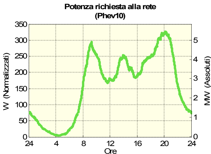
Figura 6 – Andamento della potenza richiesta alla rete per i veicoli (Phev10). Nelle scale delle ordinate a sx i valori sono riportati in valore normalizzato a veicolo, a dx in valore assoluto.
