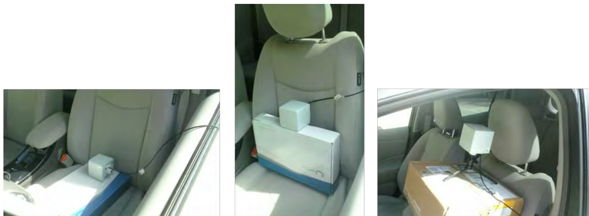
Figura 6. Misure di campo elettrico e magnetico a bordo del veicolo nei tre punti di riferimento (sedile, schienale, poggiatesta).
