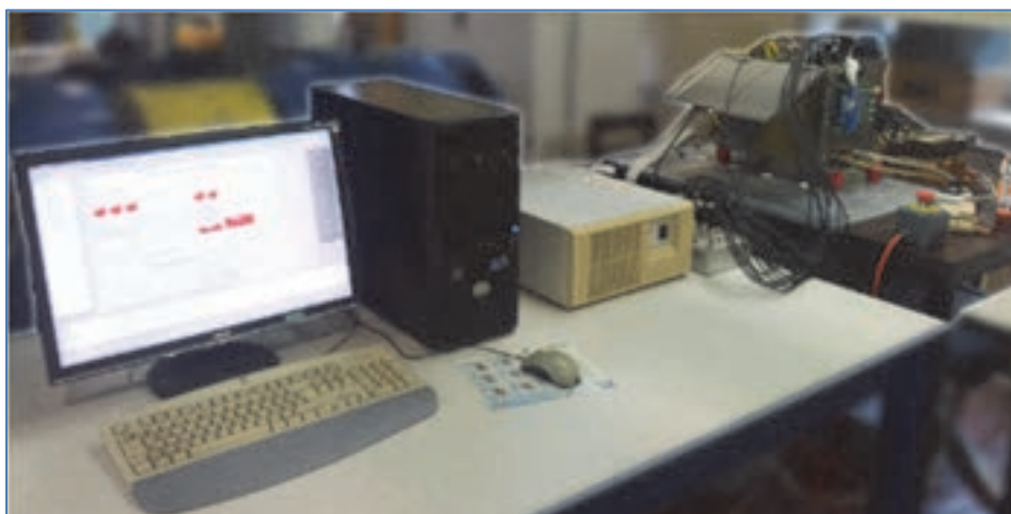
Figura 20. Host PC e dSpace DS1005 board per l'implementazione del controllo digitale del convertitore.
