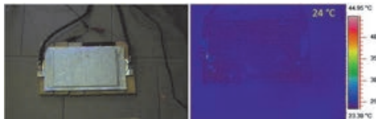
Figura 40. Cella LITHOPS da 5Ah usata per l'analisi termica e immagine termica all'inizio della scarica.
