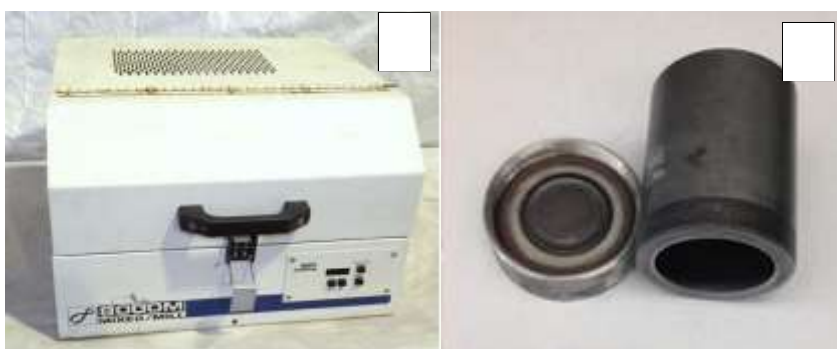
Figura 1. a) il mulino SPEX-8000M Mixer/Mill. b) il contenitore utilizzato per contenere le polveri.
