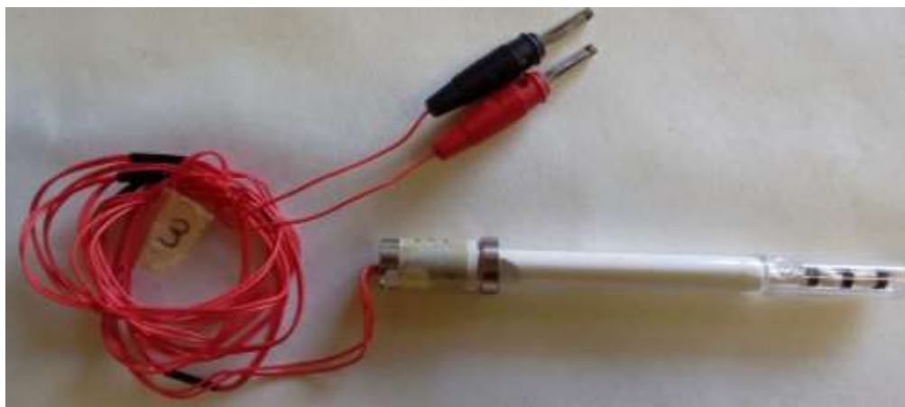
Figura 7. Cella elettrochimica in vetro, dotata di elettrodi porosi in Pt° platinato, impiegata nelle misure di conducibilità dei liquidi ionici investigati.
