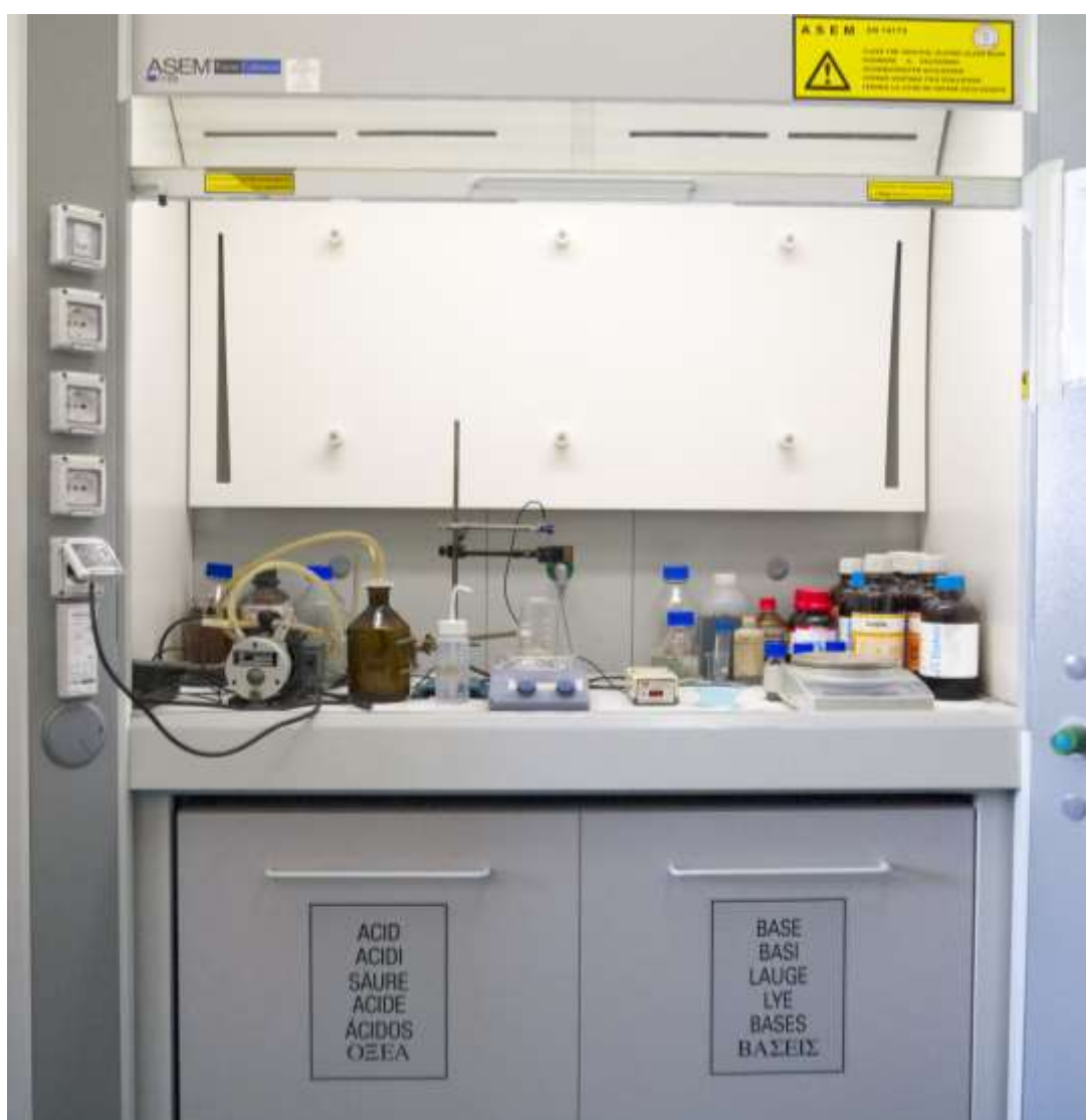
Figura 1. Immagine della cappa ad aspirazione utilizzata per il processo di sintesi dei liquidi ionici.
