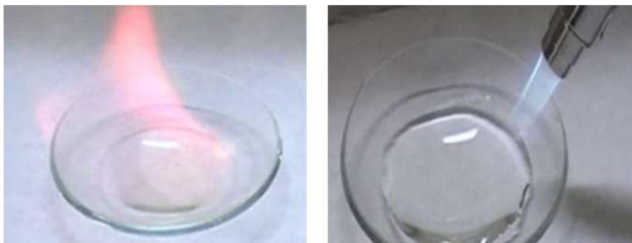
Figura 8. Test di ignizione eseguiti su solventi organici convenzionali (pannello sinistra) e sul liquido ionico PIP 13 TFSI (pannello destra).
