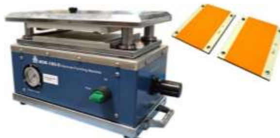
Figura 33: fustellatrice marca MTI modello MSK-180SC.
