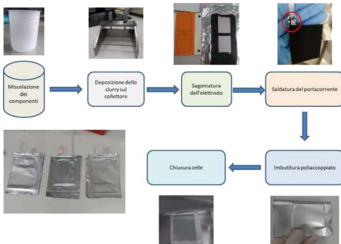
Figura 30: Rappresentazione schematica procedura di preparazione di una cella “pouch”.
