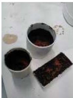
Figura 24 – I tre crogioli usati per il trattamento termico nella SINTESI VI del LNMO.
