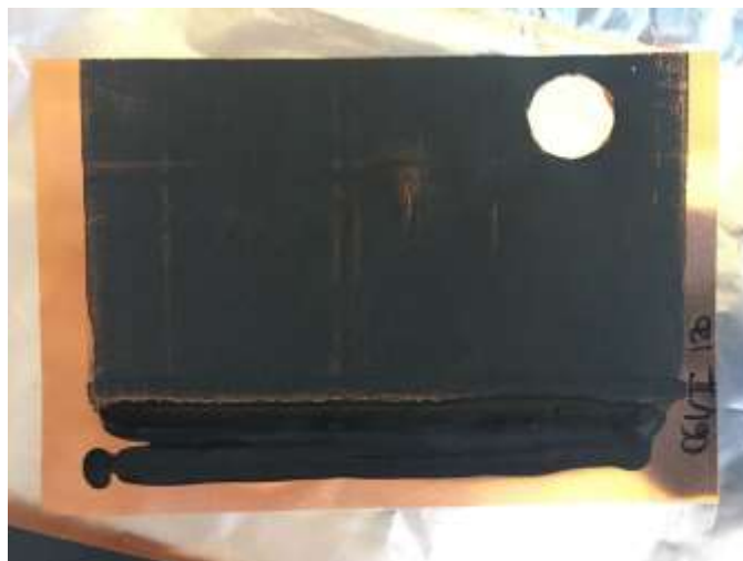
Figura 24: anodo realizzato secondo la ricetta riportata in tabella 12 su rame liscio.
