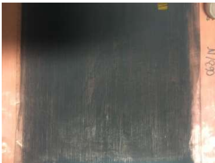
Figura 25: anodo realizzato secondo la ricetta riportata in tabella 12 su rame cotto.
