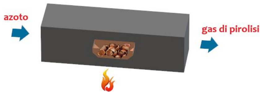
Figura 4. Schema del forno di carbonizzazione.
