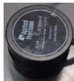
Figura 19- Probe per la misura della conducibilità/capacità termica
