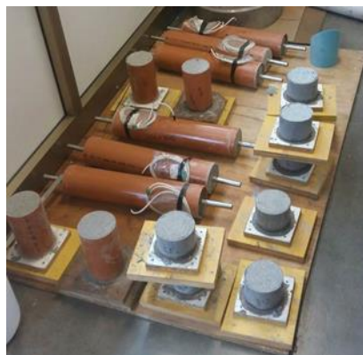
Figura 1 – Provini in calcestruzzo e calcestruzzo/diatomite/PCM.
