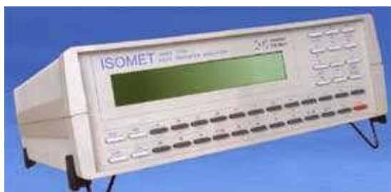
Figura 18- Dispositivo di misura ISOMET della conducibilità/capacità termica
