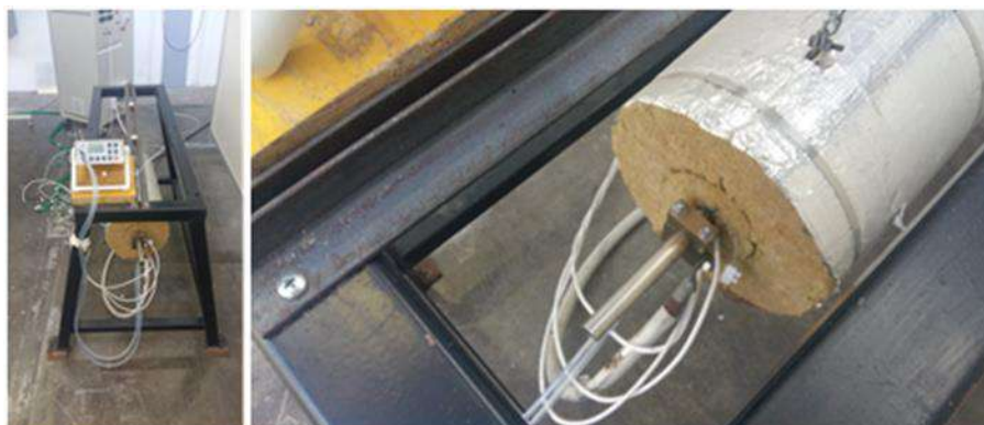
Figura 9- Sistema di acquisizione della velocità dell'aria e cavi di misura
