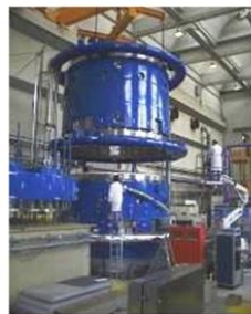
Convection naturelle dans une maquette d'enceinte (2005)
