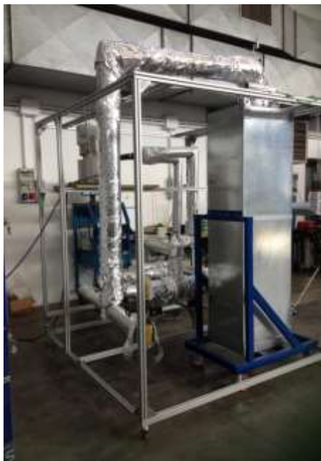
Figura 1- Impianto sperimentale ATES con un prototipo installato LHTES (ENEA-TES-LH01) a fascio tubiero da circa 8MWh
