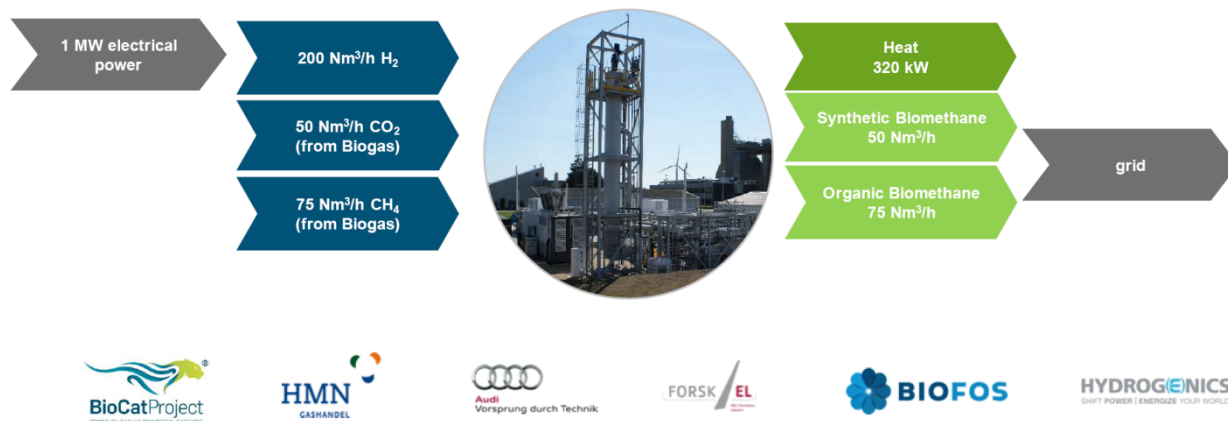
Figura 18. Schema del progetto Biocat con metanazione biologica (Danimarca)
