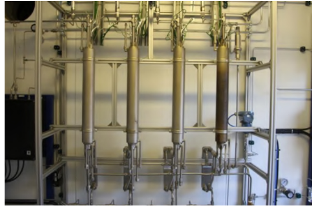
Figura 27. Quattro metanatori di P2G [141].
