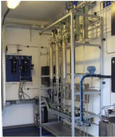
Figura 26. Sistema di metanazione P2G [141].
