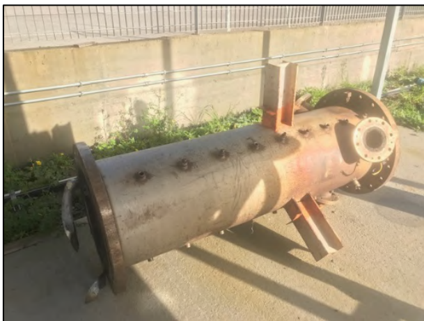
Figura 4.80 - Reattore di gassificazione dopo la rimozione e la sua movimentazione.
