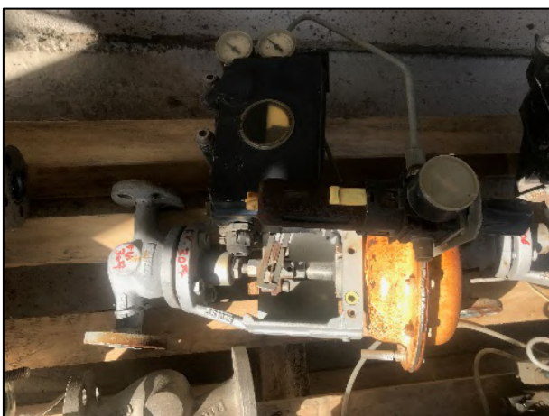
Figura 4.27 – Valvola regolatrice FV307.
