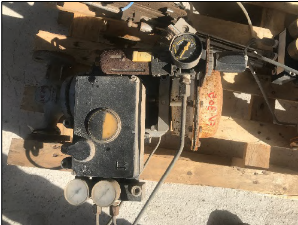
Figura 4.25 - Valvola regolatrice FV305.
