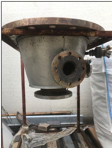
Figura 4.9 - Cono di scarico ceneri.
