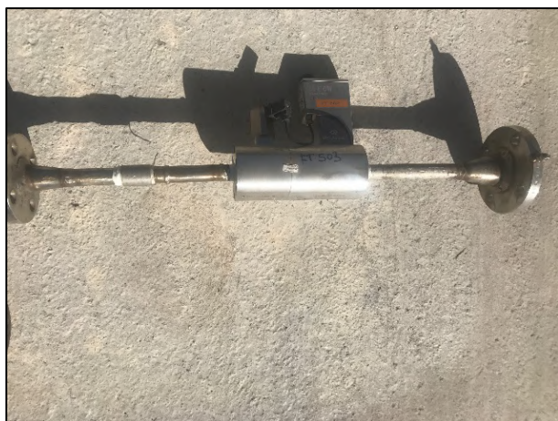
Figura 4.30 – Il regolatore massico FT502 dopo la rimozione.
