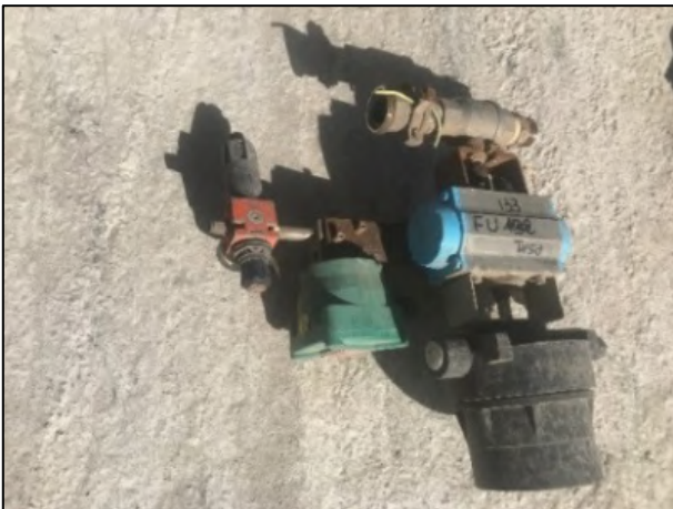
Figura 4.45- valvola di intercettazione FU133.
