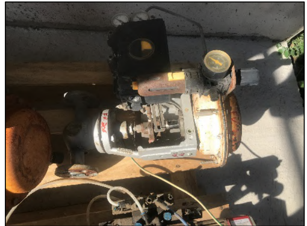
Figura 4.26 – Valvola regolatrice FV306.
