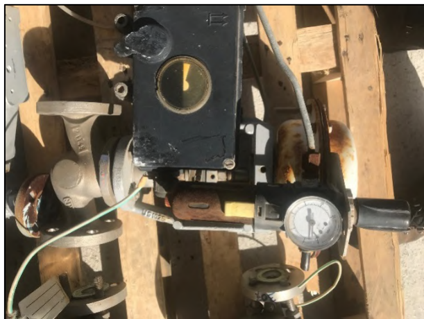
Figura 4.32 – Valvola regolatrice FV502.
