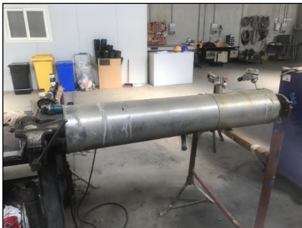
Figura 4.39 – Taglio della tubazione di spurgo dal tubo di alimentazione agenti gassificanti.
