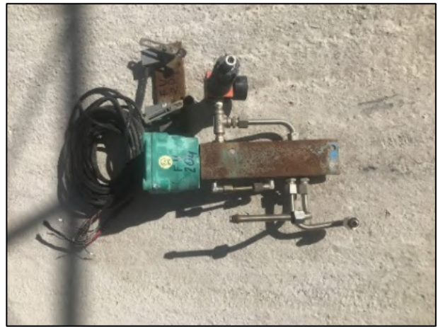
Figura 4.50 - Gruppo di comando FU204 della ghigliottina della tramoggia.
