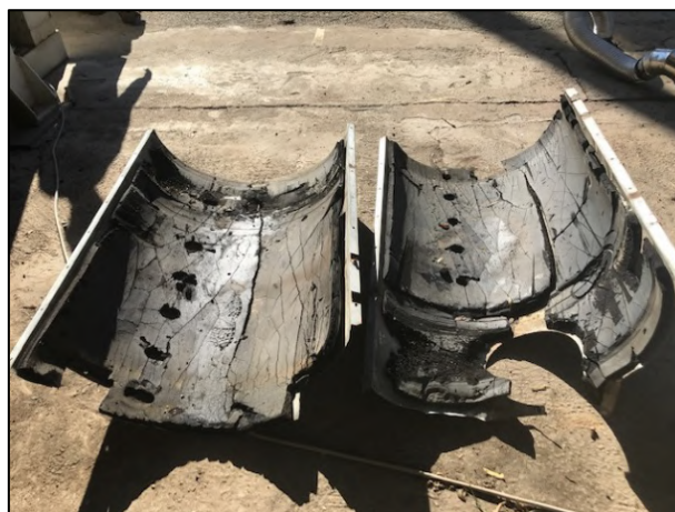
Figura 4.13 – Coibentazione rimossa dal reattore.
