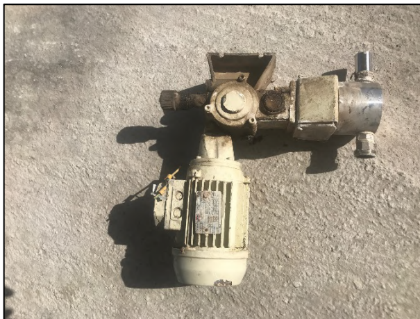
Figura 4.36 – Pompa dosatrice CF003 dopo lo smontaggio
