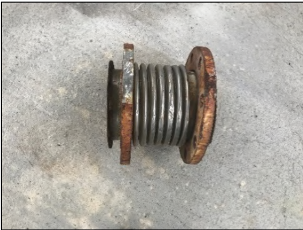
Figura 4.53 – Giunto di dilatazione DE002.
