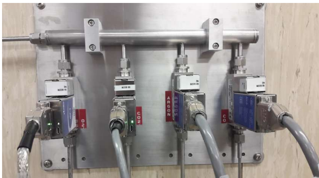
Figura 3. Sistema per la miscelazione dei gas, che è costituito da alcuni flussimetri Mass Flow Control (MFC) modelli MF-1 della MKS.
