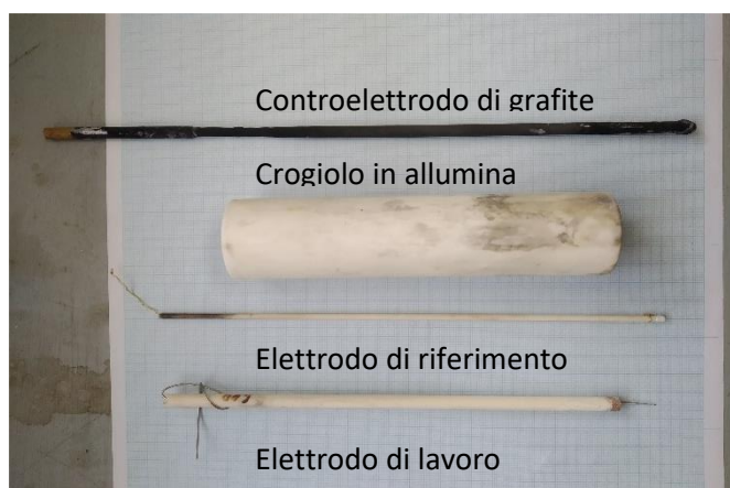
Figura 1 – Crogiolo ed elettrodi utilizzati per realizzare la cella elettrochimica a tre elettrodi.
