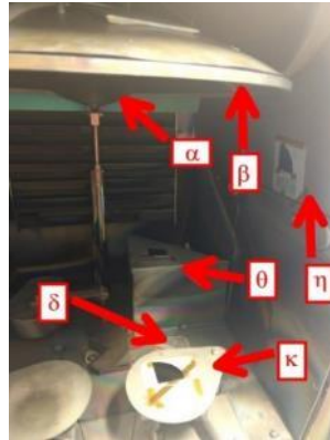
Figura 15. Camera dell'evaporatore con i substrati passivati disposti in vari punti per stimare il danneggiamento del lifetime causato dai raggi X.
