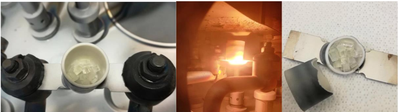
Figura 2. Tentativo di evaporazione del MgO. Da sinistra a destra, il materiale nel crogiolo, il processo ed il crogiolo rotto con il materiale all'interno intatto.
