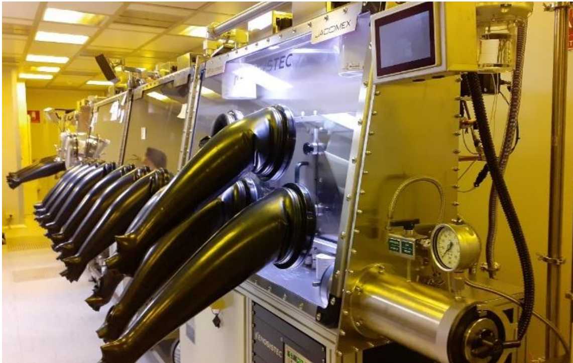
Figura 15. Foto dell'intera linea di glove box nelle camere bianche del CR ENEA di Portici, con in primo piano l'adattatore a 5 guanti del sistema di evaporazione installato (il guanto superiore sinistro si è rivelato al momento poco utile ed è stato quindi omoesso).
