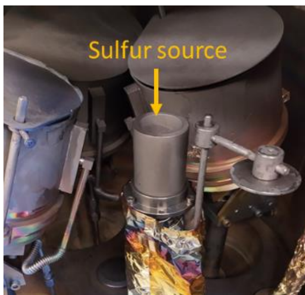
Figura 1: Foto della sorgente di evaporazione dello zolfo installata nell'impianto di co-sputtering.
