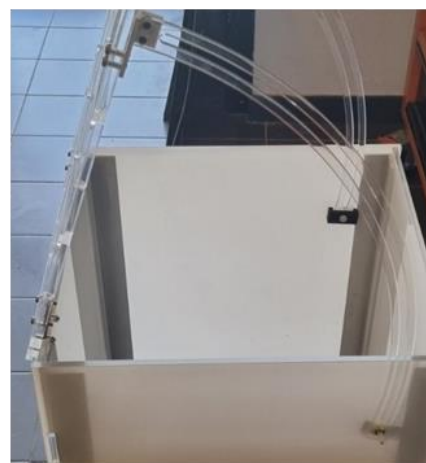
Figura 2.1.10. Box per matrici 3x3 di vetri: progetto della griglia di alloggiamento dei vetri (in alto a sinistra), progetto del goniometro (in alto a destra) e viste prospettiche del box progettato e di un prototipo realizzato in plexiglass (in basso).
