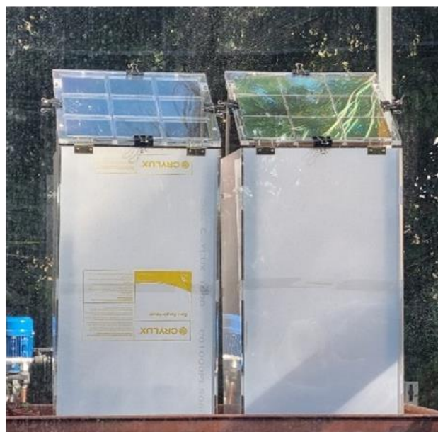
Figura 2.1.11. Foto di prototipi di box grandi durante la sperimentazione presso MUSA. Sono montati 9 campioni da 10 x 10 cm 2 per box e l'angolo di tilt è fissato a circa 30°, tipico per tetti di serre.
