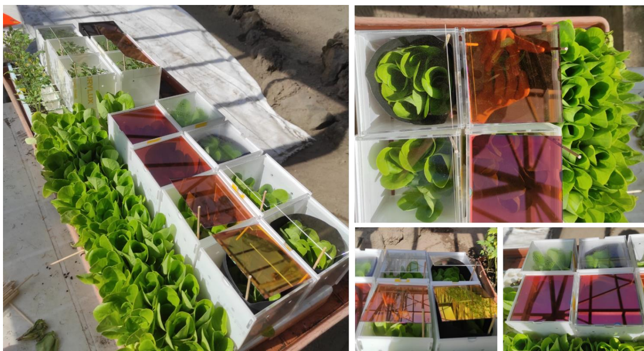
Figura 22 Sperimentazione su lattuga in serra con differenti configurazioni angolari del film sottile e diverse condizioni di luce diffusa laterale.
