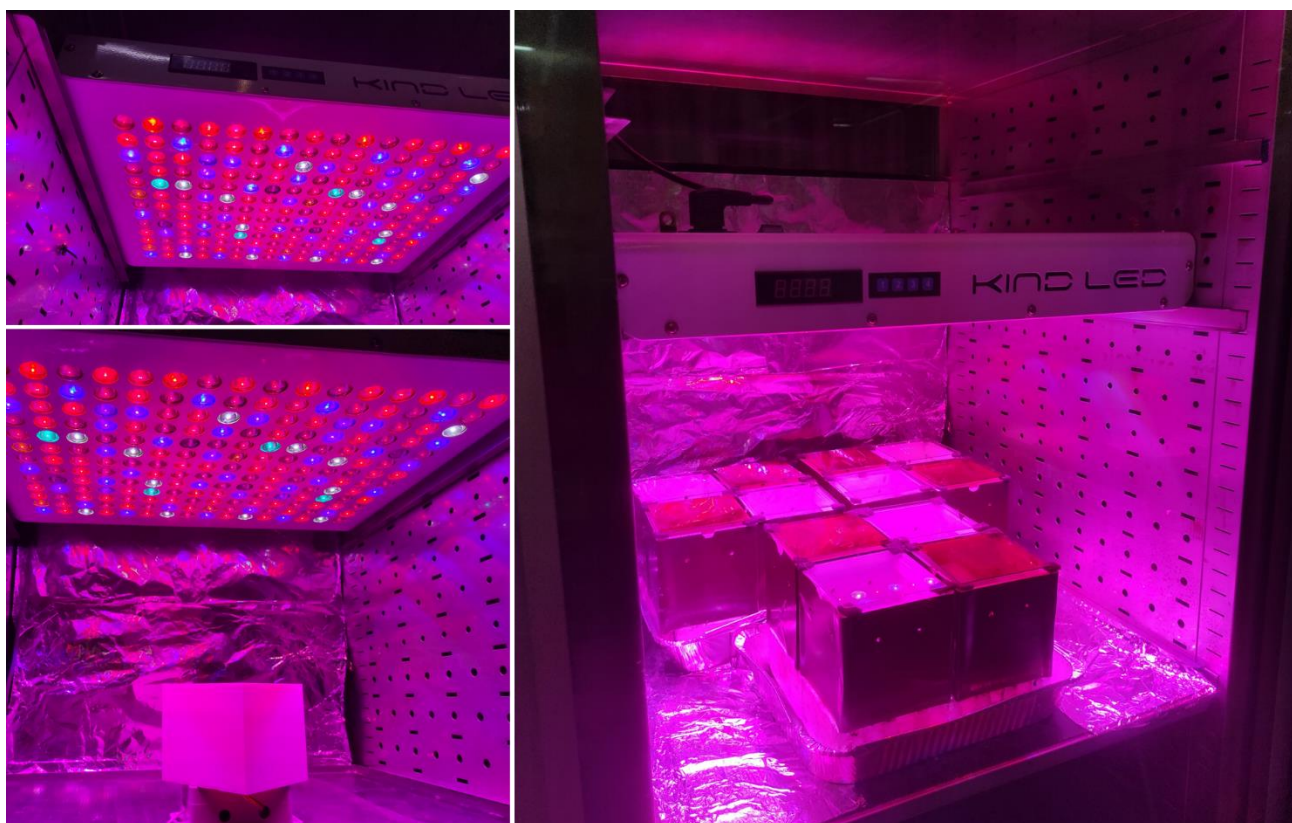
Figura 9 la camera di crescita utilizzata nella terza sperimentazione con il pannello LED (Light-Emitting Diode) (K5 Series XL750, Kind LED, Santa Rosa, CA, USA)
