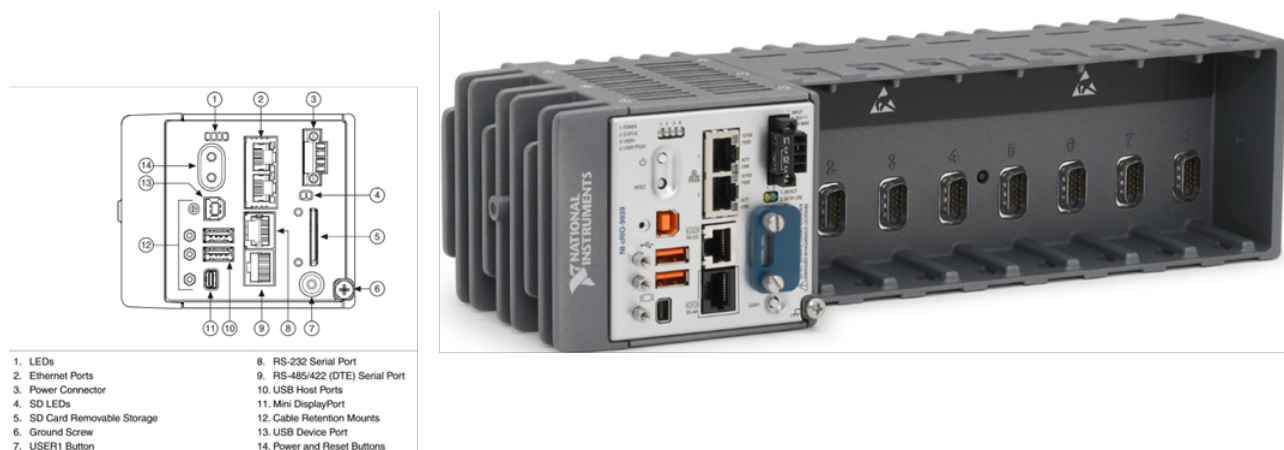
Figura 1. Controller cRIO-9035. A sinistra schema del pannello frontale, porte e connettori. A destra vista d'insieme.
