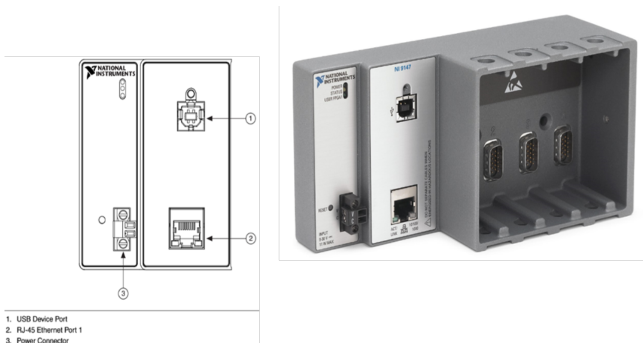
Figura 2. Chassis Ethernet di espansione NI-9147. A sinistra schema del pannello frontale, porte e connettori. A destra vista d'insieme.
