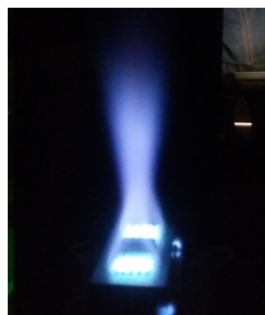
Figura 2 Immagine della fiamma principale e delle due fiamme pilota. Nella foto è stata rimossa temporaneamente la camera di combustione in quarzo.
