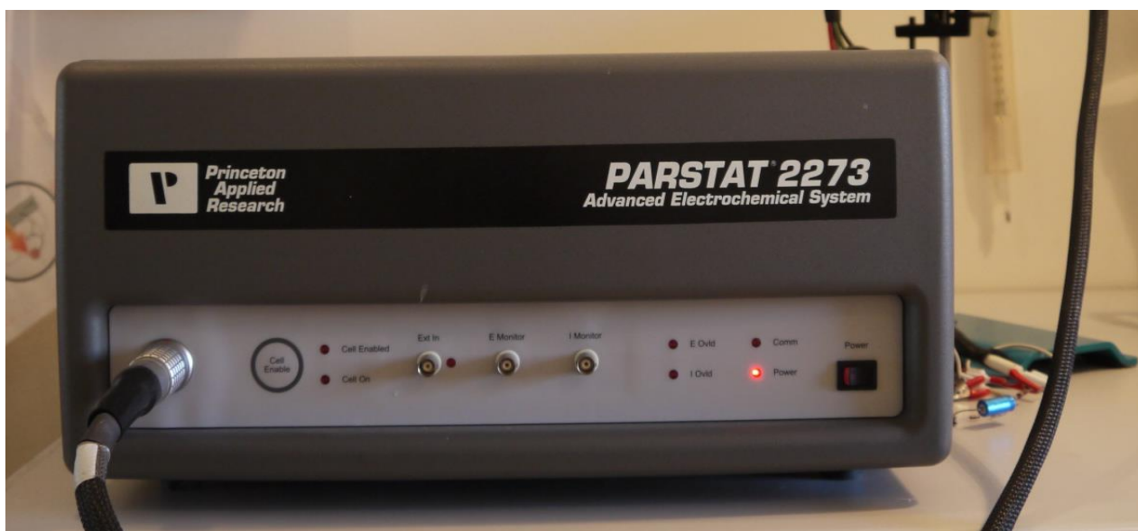
Figura 5. Potenziostrato/galvanostato, combinato con un ponte di impedenza, utilizzato per le misure voltammetriche.
