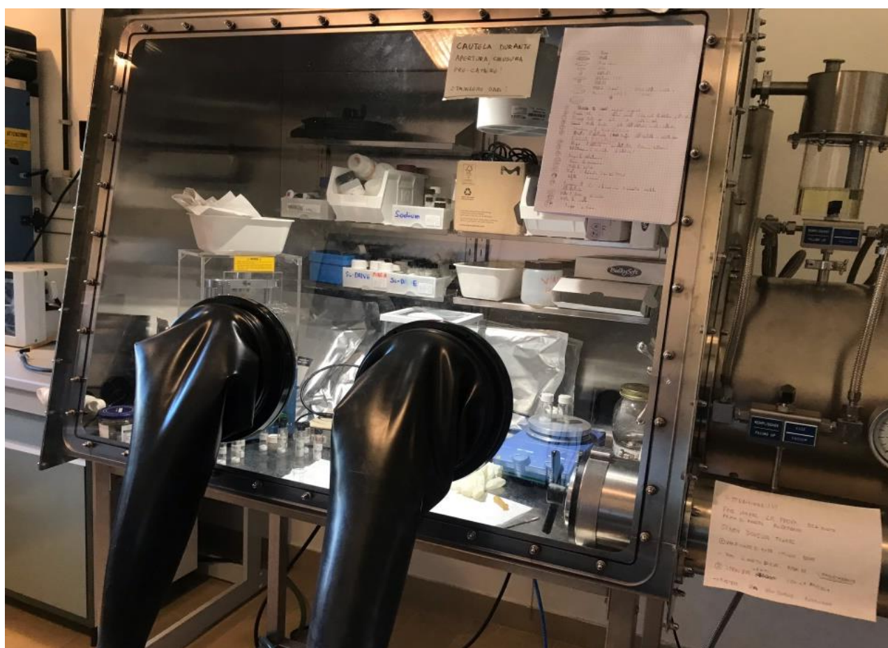
Figura 1. Scatola a guanti per la manipolazione degli elettroliti e l'assemblaggio delle celle elettrochimiche.
