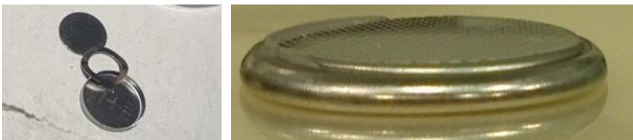
Figura 3. Coin-cell 2032 realizzata per l'esecuzione delle misure elettrochimiche.
