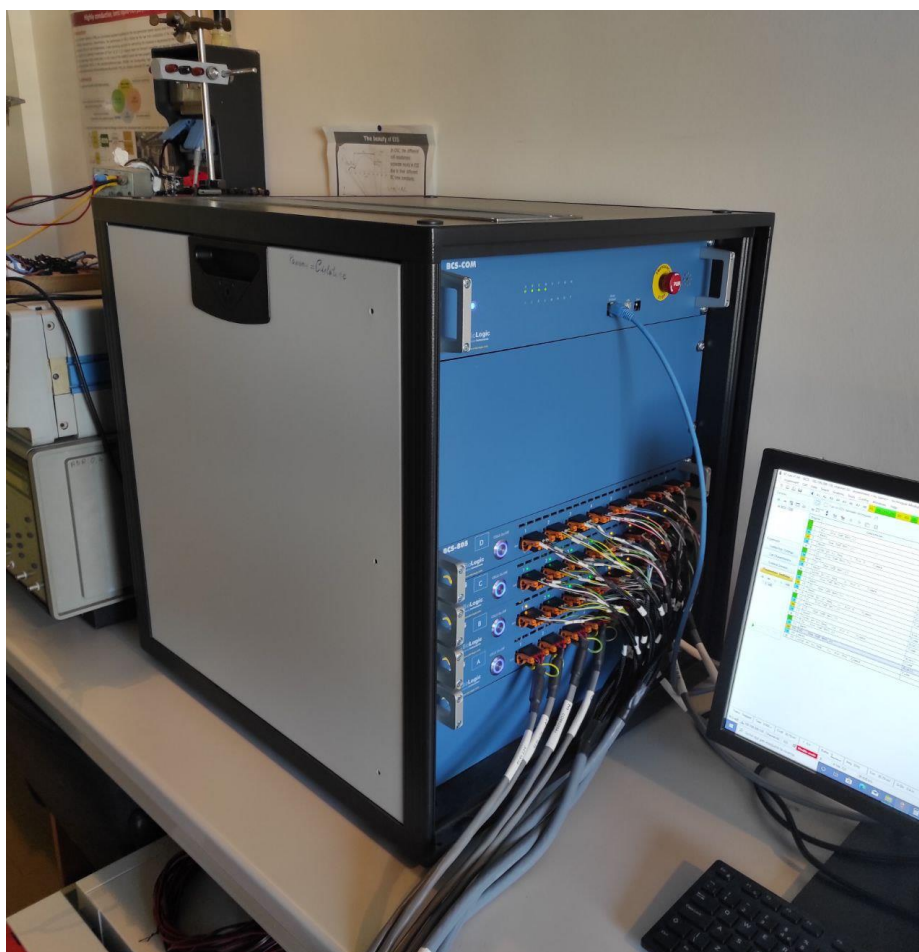
Figura 6. Ciclatore multicanale utilizzato per i test di carica/scarica delle celle elettrochimiche.
