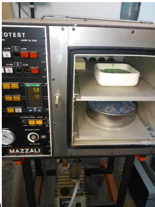
Figura 4 – a) Foto della stufa con il crogiolo durante l'essiccazione del gel e b) Foto del materiale essiccato
