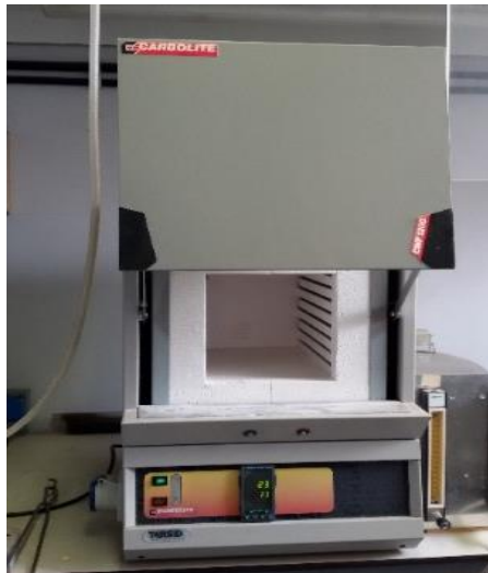
Figura 8 - Forno con programmatore usato per entrambi le fasi di cottura del \text{NaLi}_{0,2}\text{Ni}_{0,25}\text{Mn}_{0,75}\text{O}_2
