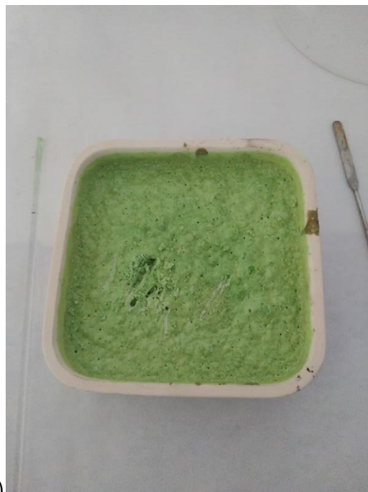
Figura 4 – a) Foto della stufa con il crogiolo durante l'essiccazione del gel e b) Foto del materiale essiccato
