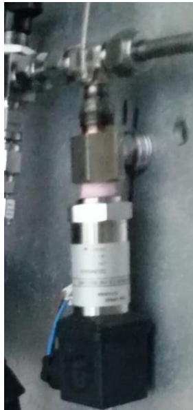
Figura 19. Particolare del trasduttore di pressione per la misura della pressione a valle del reattore.
