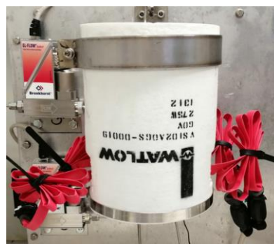
c) Particolare del preriscaldatore dei gas in ingresso al reattore alloggiato nel refrattario ceramico.
