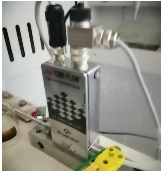
Figura 21. Particolare del misuratore di portata massica ad effetto Coriolis.
