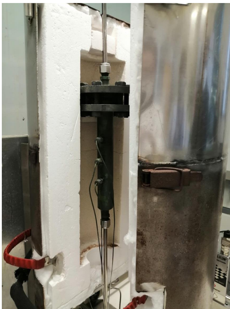
Figura 15. Particolare del reattore alloggiato nel refrattario ceramico
