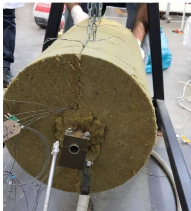
Figura 3-6 Provino con tubo immerso coibentato ed alloggiato sull'impianto Solteca-Air
