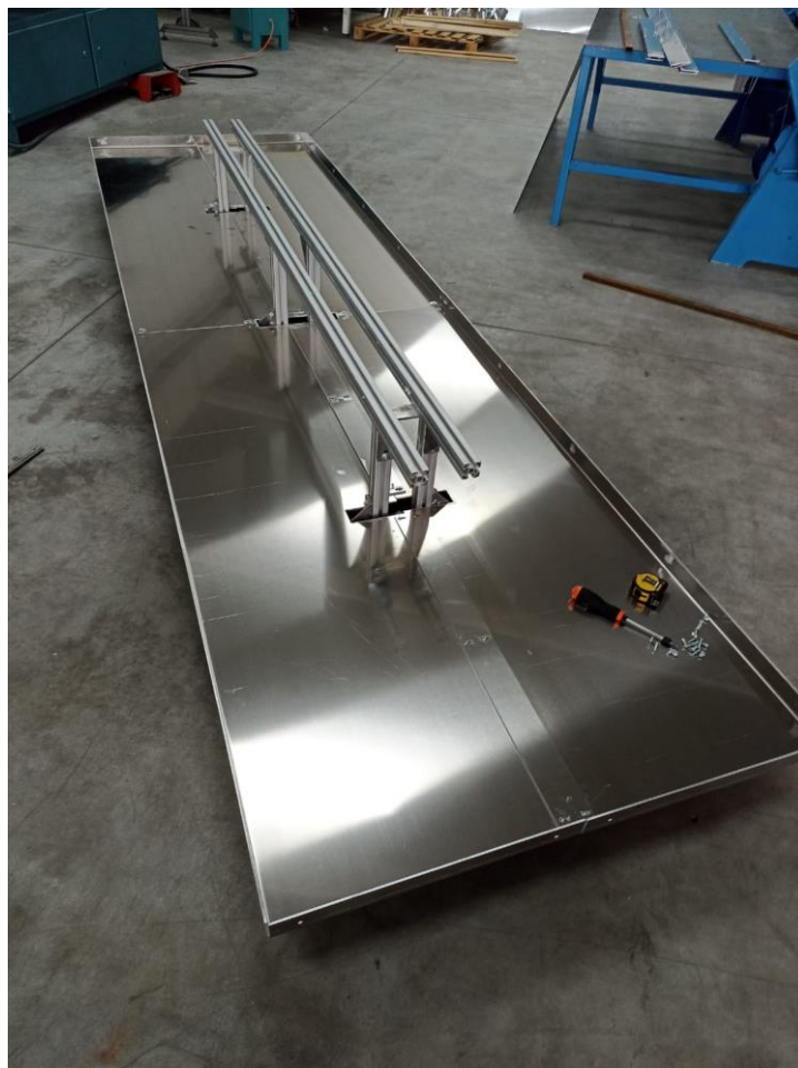
Figura 3-1- Pavimento e carrello del sistema di coibentazione del modulo cementizio.
