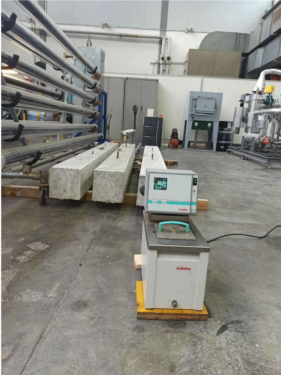
Figura 3-4 - circolatore riscaldatore Julabo SE nella procedura di degassamento del modulo cementizio.
