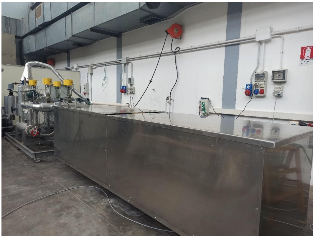
Figura 3-8 – Sistema di coibentazione completato e con il modulo cementizio inserito.
