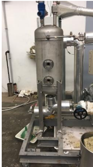
Figura 2-2- Serbatoio olio diatermico.
