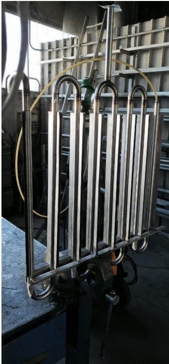
Figura 3- Fasi di assemblaggio dello scambiatore del prototipo ENEA-TES/LH02: i) realizzazione dei singoli tubi alettati; ii) realizzazione di parte di una serpentina; iii) assemblaggio dello scambiatore completo.
