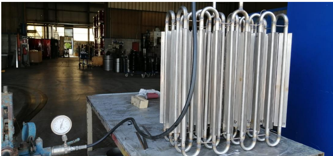
Figura 4- Prototipo ENEA-TES/LH02. Prova di tenuta idraulica a 10 bar.
