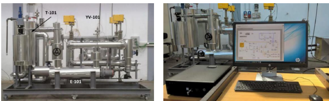
Figura 2-1- Impianto Solteca3 e consolle di controllo.
