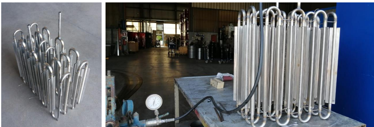
Figura 2-4 Elemento base: vista dello scambiatore realizzato (sinistra) e sua prova di tenuta a 10 bar (destra).
