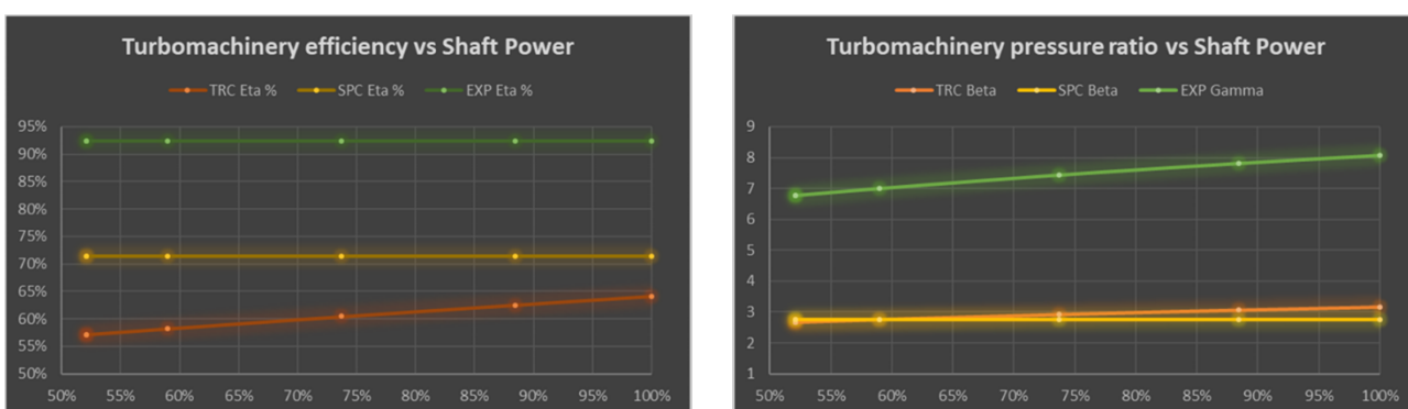
Figura 15. Efficienza delle turbomacchine in funzione della potenza netta all'albero (sinistra), rapporti di compressione dei compressori transcritico e supercritico al variare del set point di potenza.
