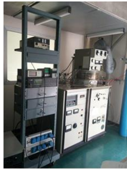
Figura 2. Impianto MRC 8620 per la deposizione mediante PVD.
