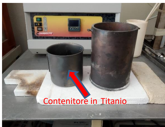
Figura 13 – Foto della cella di elettrolisi assemblata e dei contenitori di titanio (interno) e di acciaio inox (esterno).
