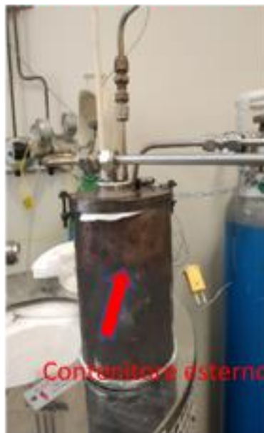
Figura 13 – Foto della cella di elettrolisi assemblata e dei contenitori di titanio (interno) e di acciaio inox (esterno).
