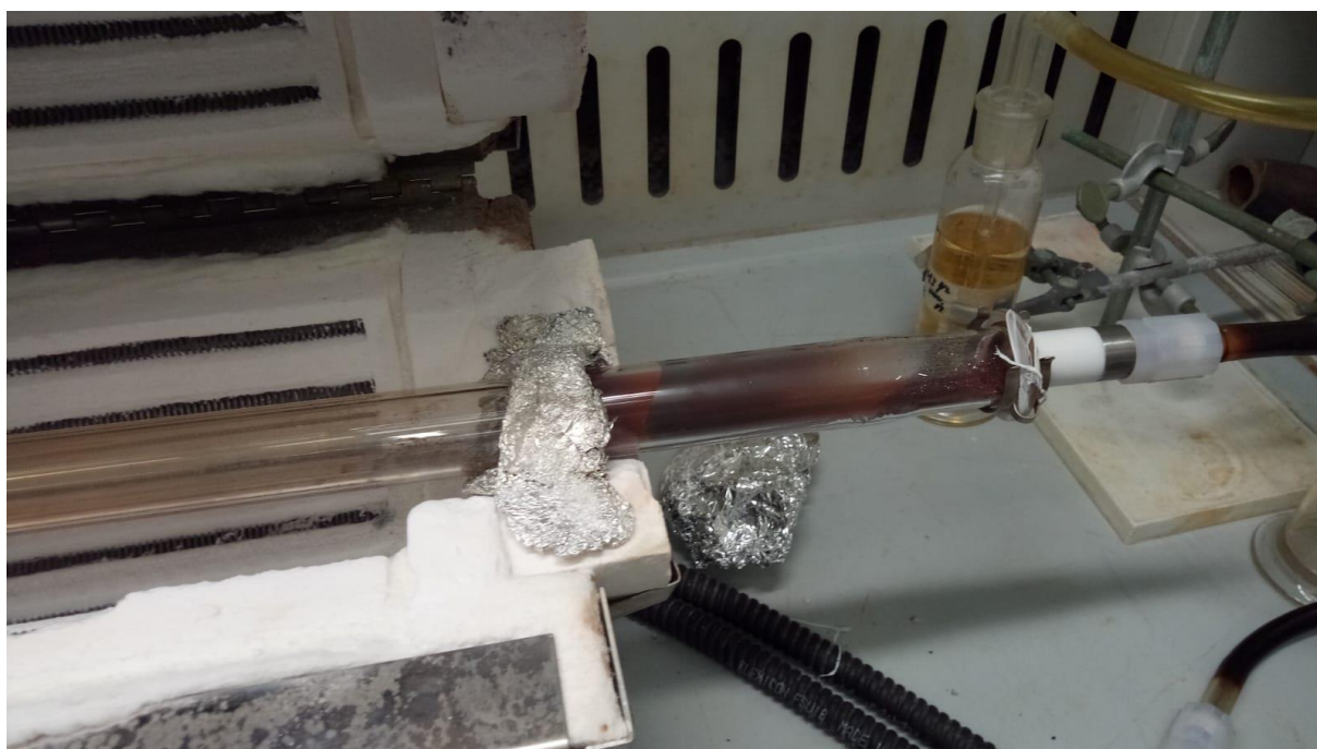
Figura 18– Decomposizione termica di \text{FeI}_2 : lo ioduro è evaporato dal contenitore in allumina e si è depositato all'uscita del reattore, e parzialmente nella trappola con KI, la quale simula il reattore di Bunsen presente nel ciclo termochimico.
