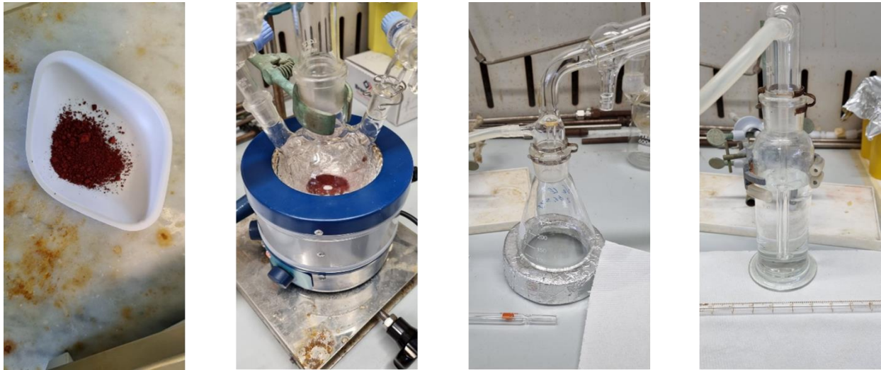
Figura 8 – Particolari della preparazione del sistema sperimentale per la formazione del solfato di ferro (III): da sinistra, l'ossido di ferro (III) Fe_2O_3 utilizzato, l'inserimento dei reagenti nel pallone con ancorotta magnetica per l'agitazione, la trappola vuota di sicurezza e la trappola contenente una soluzione di NaOH 1N.
