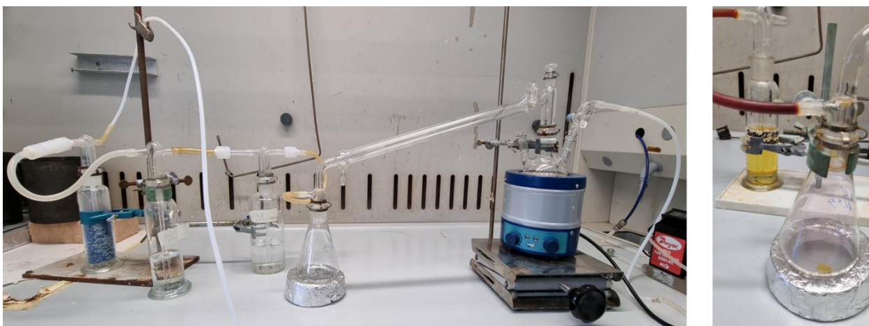
Figura 17 – Sistema utilizzato per la sintesi di \text{FeI}_2 . È analogo a quello utilizzato per la sintesi dei solfati, ma l'azoto è usato come carrier gas e la trappola contiene una soluzione di KI in grado di trattenere lo iodio formato per riduzione (da parte dello ioduro) dell'ossido ferrico presente come impurezza (figura a destra). La reazione avviene intorno a 100^\circ\text{C} e l'acido e l'acqua residui vengono rimossi a circa 200^\circ\text{C} . Il tempo di reazione è stato di circa 2 ore.
