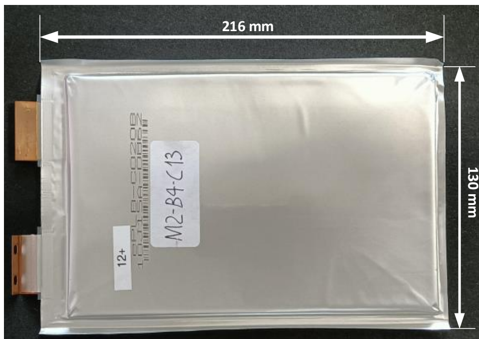
Figura 2 foto della cella LiPO EIG ePLB-C020 utilizzata in questo progetto.
