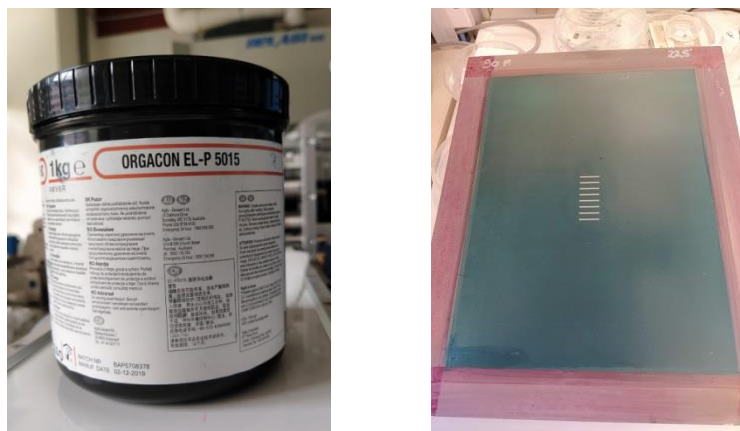
Figura 18: Pasta serigrafica AGFA e nuovo telaio
