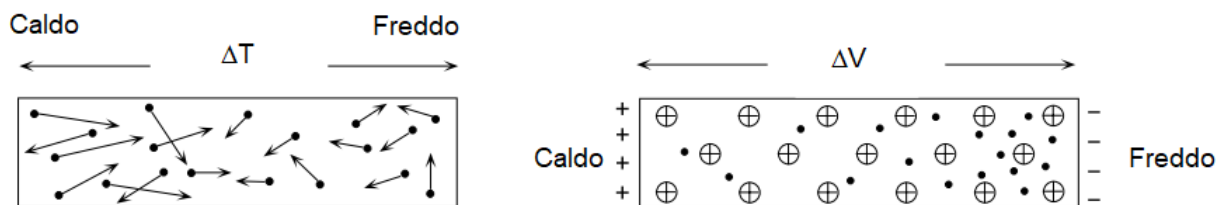
Figura 1. Movimento dei portatori di carica con gradiente spaziale di temperatura
