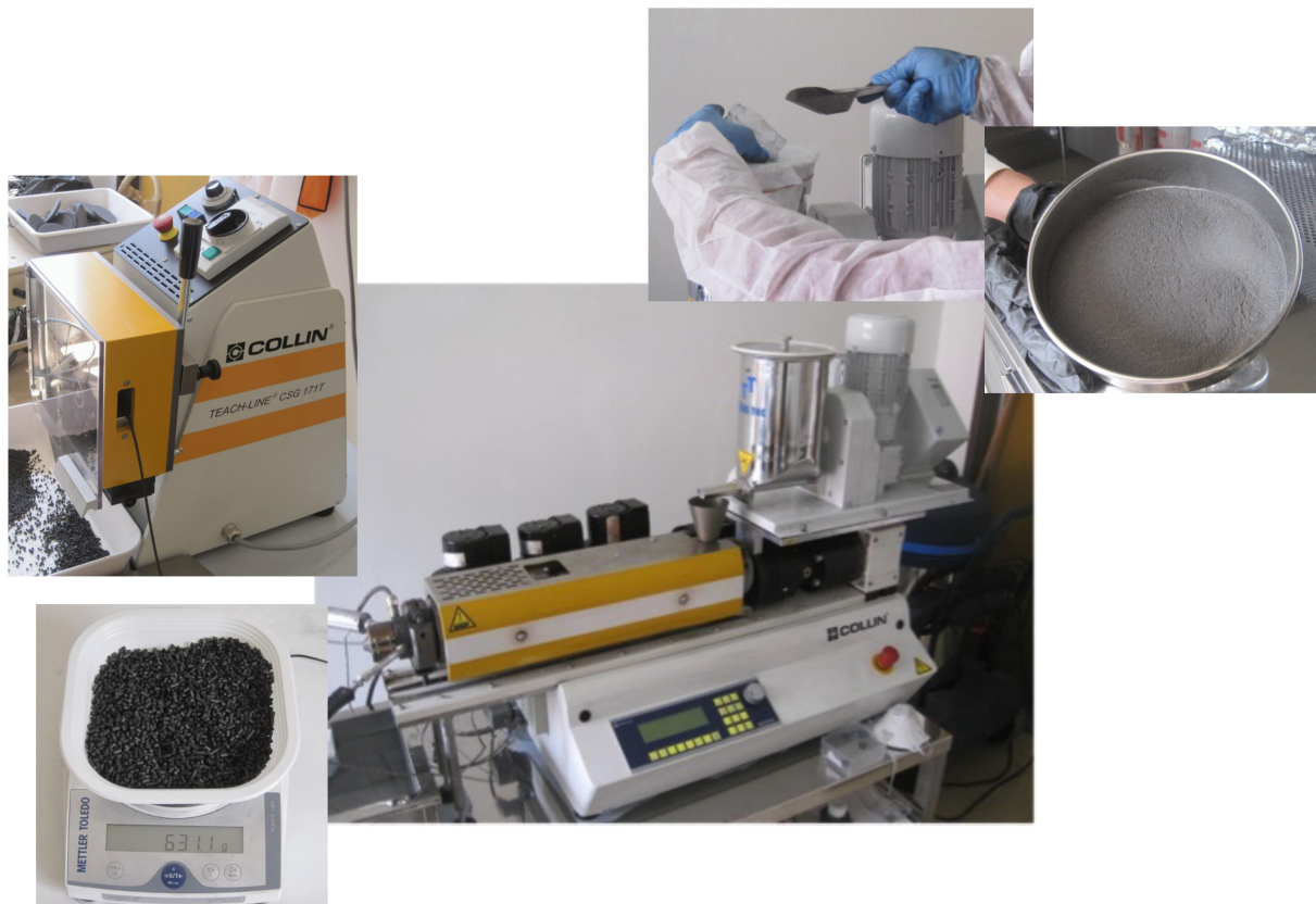
Figura 1.7. Estrusore bivate da banco Collin ZK 25T, Dr. Collin GmbH, installato presso il laboratorio ENEA MATPRO del centro ricerche Casaccia. L'estrusore è stato già utilizzato per preparare un composito metallo/polimero ad alto carico di metallo (progetto europeo HP-ACS). Negli inserti sono mostrate la fase di carico della miscela metallo/polimero e il materiale finale estruso e ridotto in pellet per mezzo di una taglierina automatica posizionata a valle dell'estrusore.
