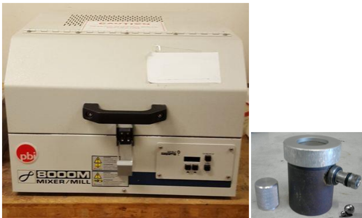
Figura 1: apparato e giare per la macinazione delle polveri (SPEX 8000)
