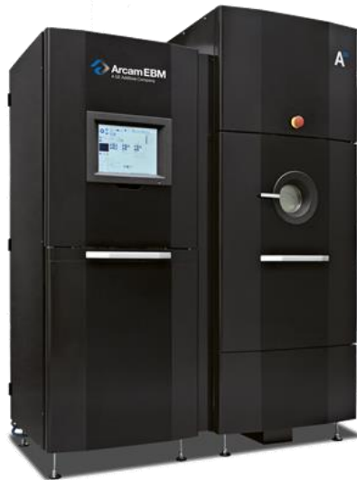
Figura 14. Stampante Arcam A2X con cui sono stati stampati i cilindri e le piastre in Ti-6Al-4V.
