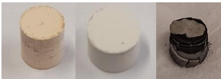
Figura 11. Campioni verdi e sinterizzato di nanopolvere NL (da sinistra: verde, verde ottenuto con la polvere post-trattata e sinterizzato)
