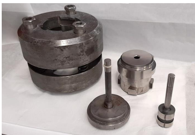
Figura 4. Stampo di acciaio per forme cilindriche e accessori della pressa uniassiale
