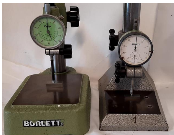
Figura 8. Comparatori per la misura del diametro (sinistra) e dello spessore (destra) dei campioni
