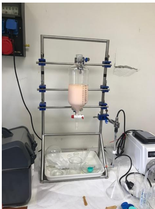
Figura 10. Serbatoio in vetro durante il lavaggio di ZnS
