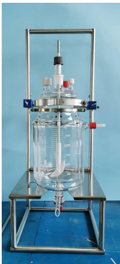
Figura 9. Reattore in vetro dell'impianto pilota
