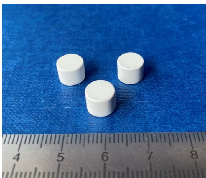
Figura 6. Componenti ceramici verdi ottenuti compattando la polvere micrometrica di ZnS mediante pressa uniassiale e poi isostatica a freddo.
