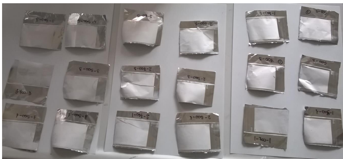
Figura 3. Prove di stampa del PVDF su alluminio.
