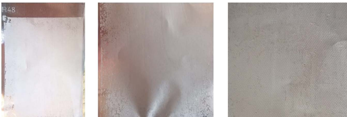
Figura 4. Esempi di difetti di stampa ottenuti: vuoti, scarsa coprenza, stampa a “retino”.
