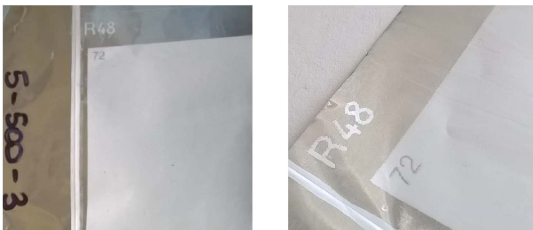
Figura 5. Esempio di stampa ottimale di PVDF su alluminio e dettaglio di stampa.
