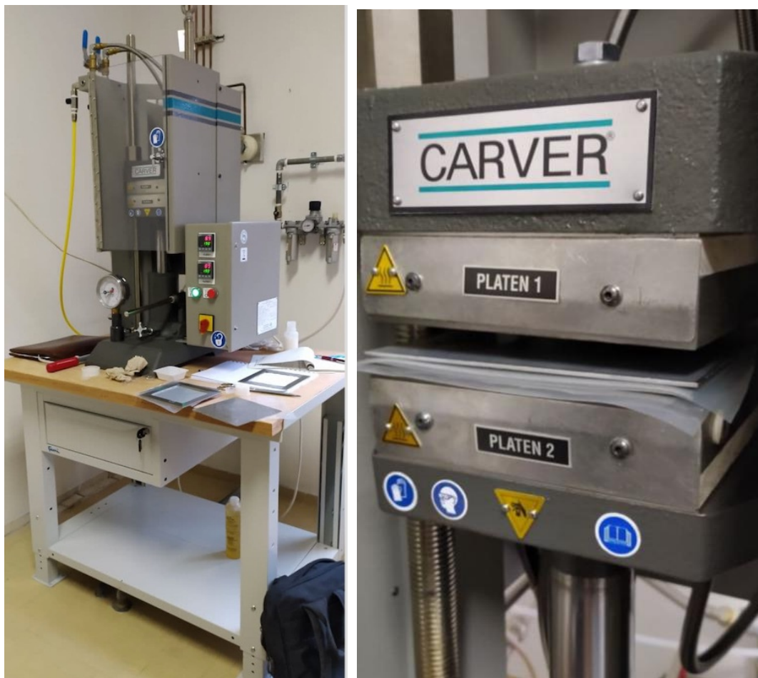
Figura 44. Pressa isostatica riscaldata modello Carver CH 4386. A destra una immagine relativa alla preparazione di un provino di polietilene utilizzando uno stampo di forma quadrata.
