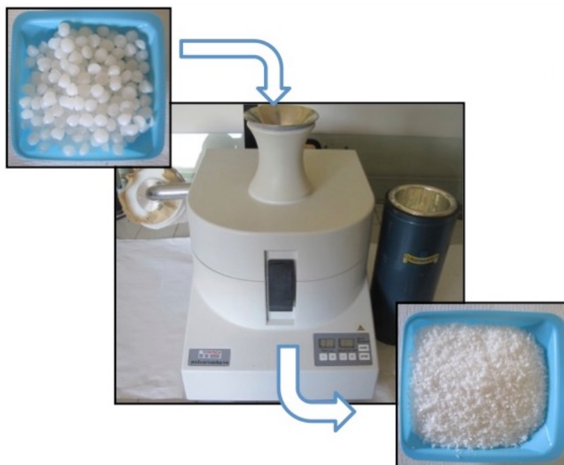
Figura 41. Mulino a coltelli Pulverizette 14 – Fritsch. Il polimero in forma di granuli viene preliminarmente tenuto in immersione in un dewar (sulla destra nell'immagine) contenente azoto liquido, in questo modo il materiale plastico si infragilisce, il processo di frantumazione in polvere risulta più efficace, si riducono i rischi di degrado dovuti a eccessivo innalzamento locale della temperatura. Il materiale infragilito viene inserito dall'alto nel mulino in rotazione e recuperato nella sacca (sul lato sinistro dell'immagine).
