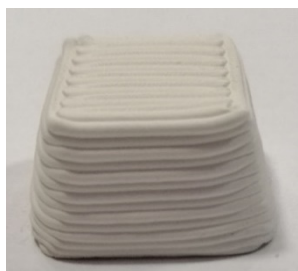
Figura 17. Immagini delle stampe 3D del G-code "001_4.3Block2151ONEwall07" con la pasta di alluminio titanato "HASE 2": campione "Tialite - 001"
