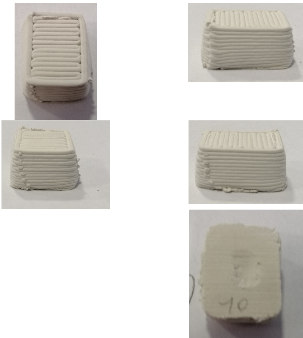
Figura 27. Immagini delle stampe 3D del G-code "010_4.3Block2151ONEwall07" con la pasta di alluminio titanato "HASE 2": campione "Tialite – 010"
