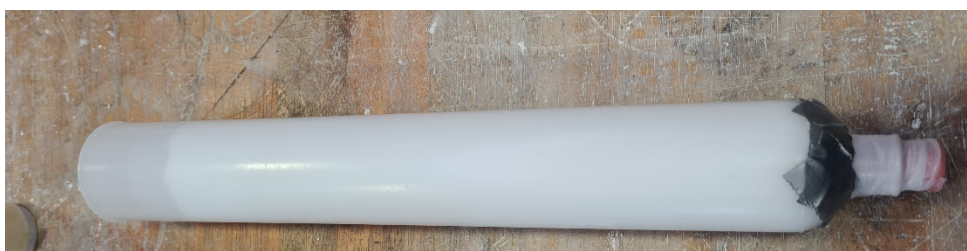
Figura 32. Pasta ceramica sperimentale “HASE 2” preparata per la stampa dell'alluminio titanato in verde
