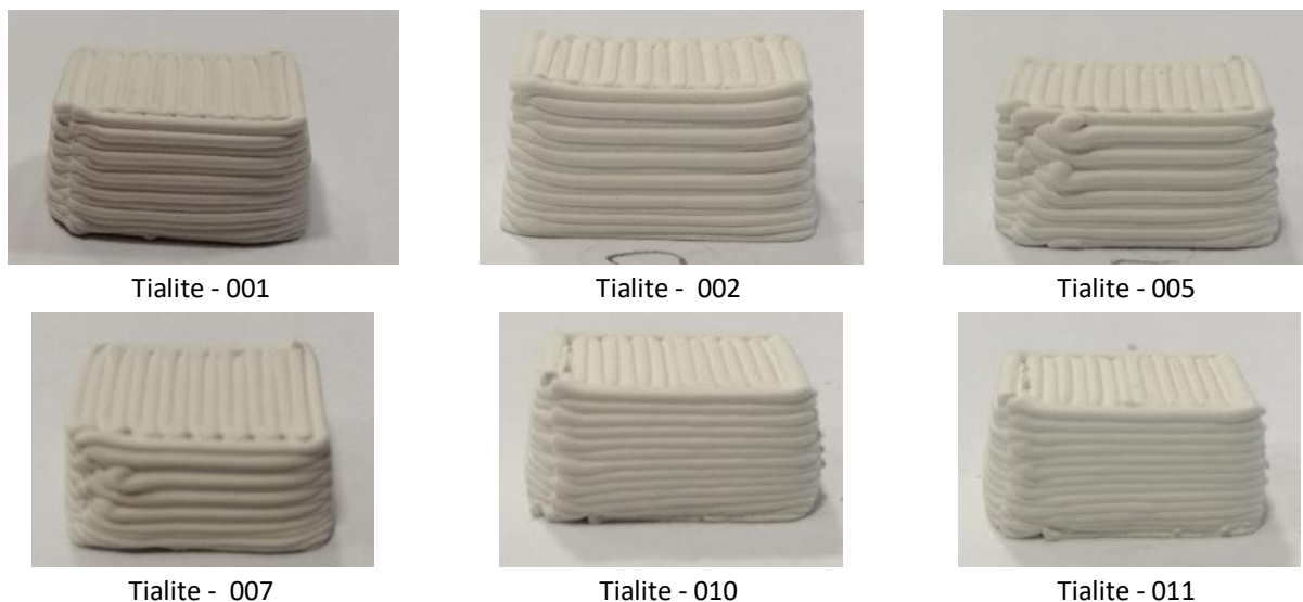
Figura 28. Campioni di alluminio titanato in verde da stampa 3D LDM (Output LA3.2)
