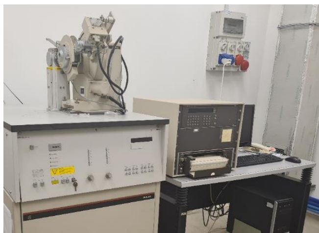
Figura 2. Diffrattometro a raggi X installato presso i Laboratori ENEA di Faenza
